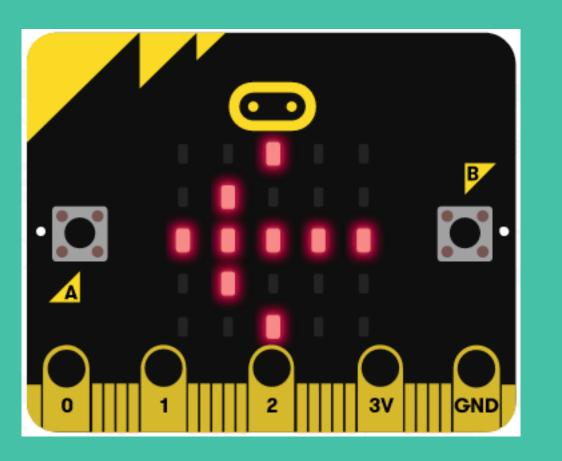
La température mesurée par le micro:bit est celle de son processeur proche de la température réelle
